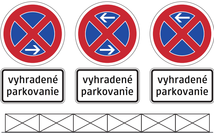
Príklad označovania viacerých vyhradených parkovacích miest. Dopravná značka s dvomi šípkami, Pokračovanie územnej platnosti značenia sa môže využiť, ak je v úseku vyznačených 6 a viac boxov. | Grafika: MČ
